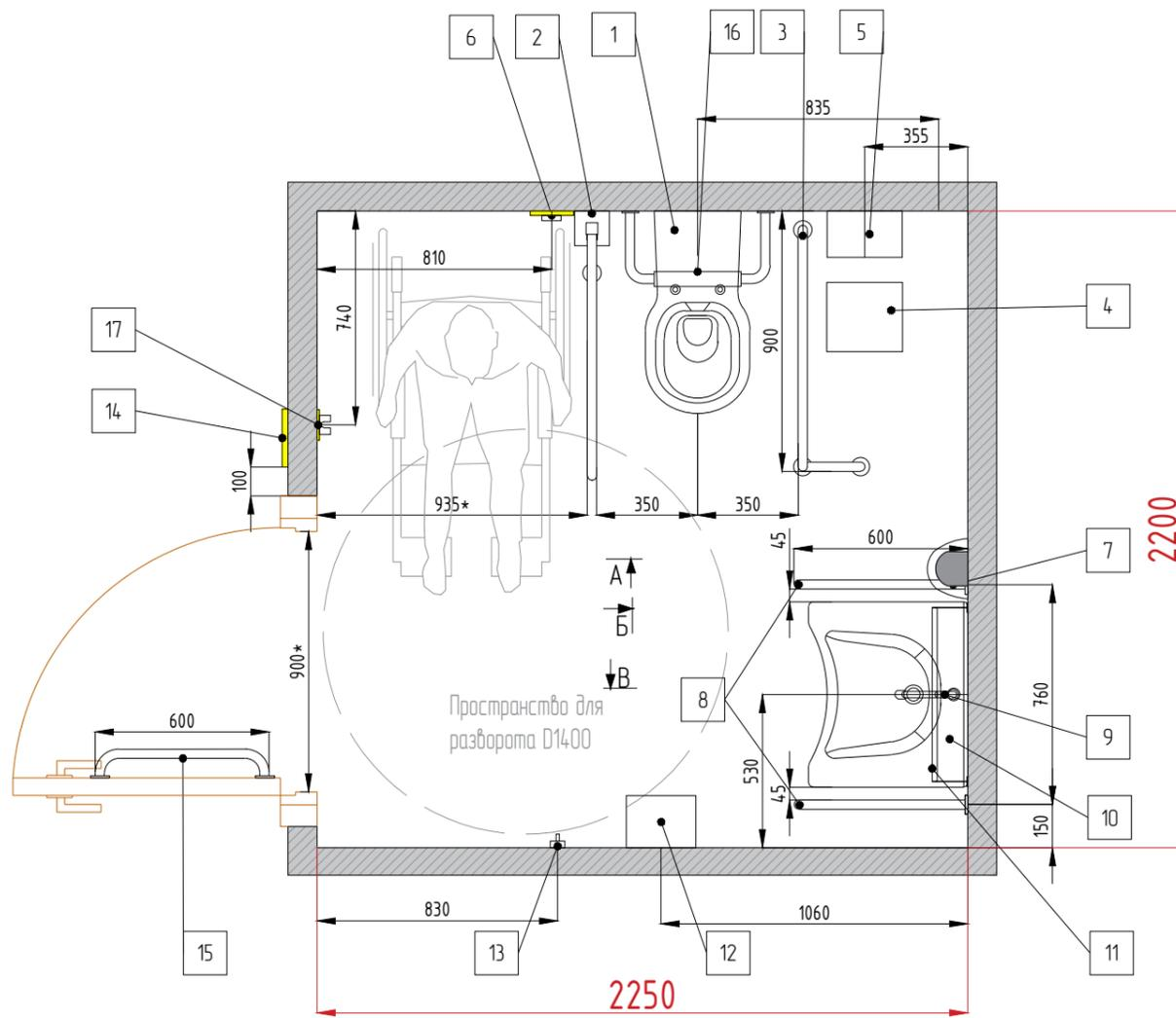
Схема установки поручня на дверь
